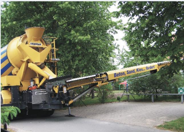
Den Mischwagen entspannt und stressfrei ausserhalb positionieren. Das Förderband bis 16,50 m ausfahren - wo der Einsatz von Radladern, Pumpen und Manpower unwirtschaftlich ist....
